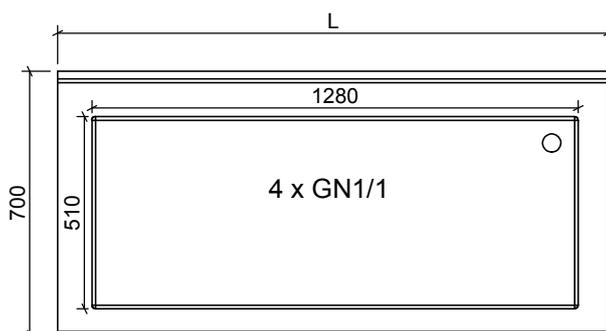
Cuve profondeur 230 mm
