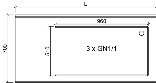
Cuve profondeur 230 mm
