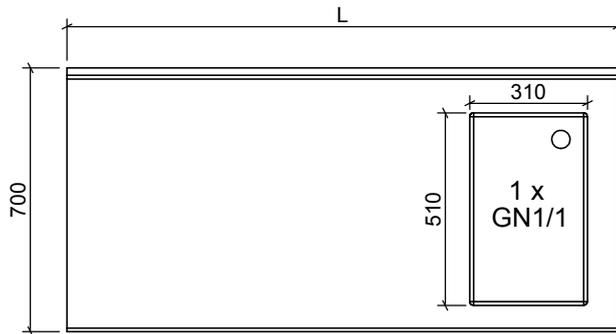
Cuve profondeur 230 mm
