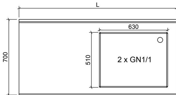
Cuve profondeur 230 mm
