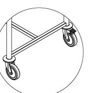
$\begin{array}{c} \text{Mobile avec 4 roues} \ \ \emptyset \ 125 \\ \text{et butoirs} \\ \text{( 2 à frein + 2 sans frein )} \end{array}$
